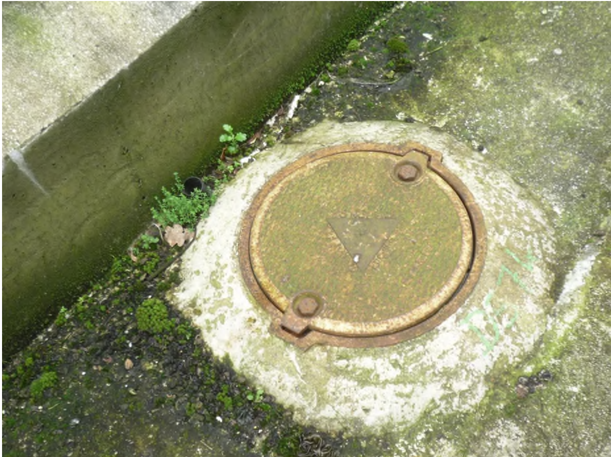
Tête de piézomètre avec tête EMCO
