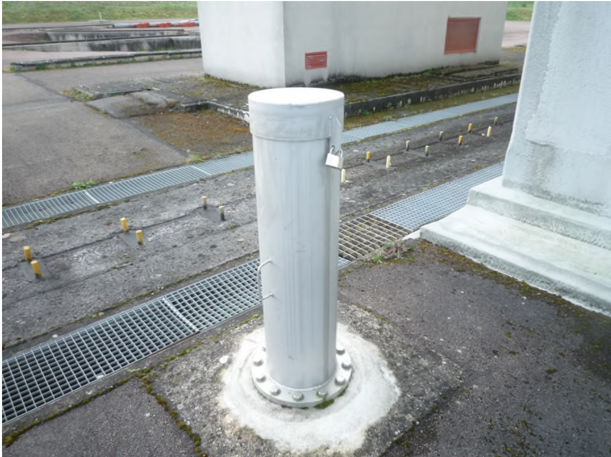
Exemple de piézomètre avec tête amovible mécano soudée
