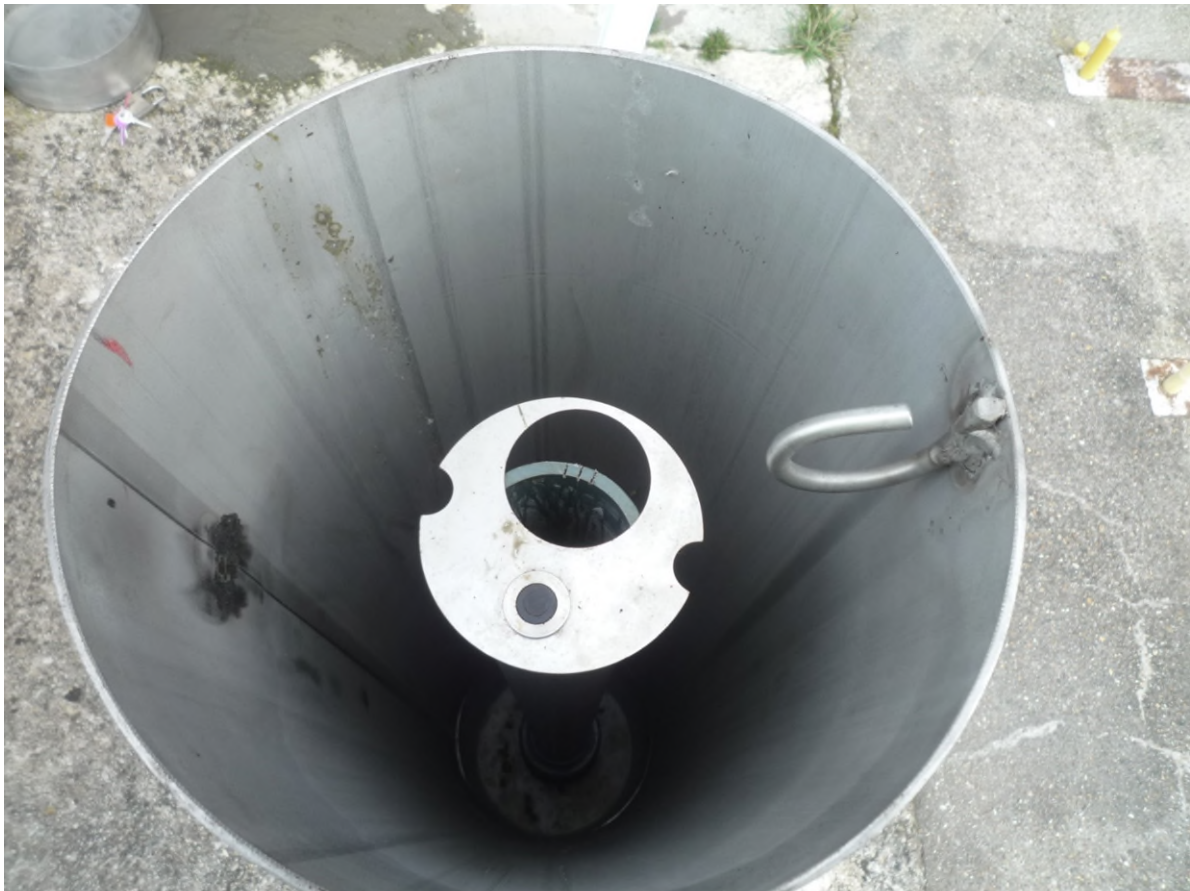
Tube du piézomètre instrumenté
